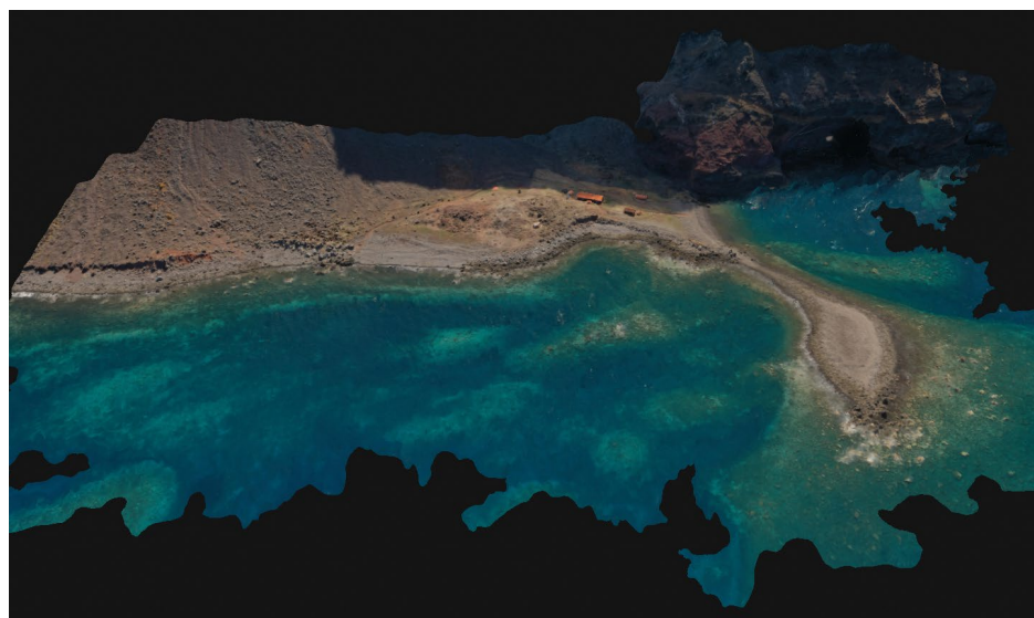
Modelo tridimensional de zona costeira na ilha da Desert Grande, utilizado em mapeamento de habitats recorrendo a drones e veículos de superfícies tripulados remotamente, João Monteiro / MARE-Madeira
