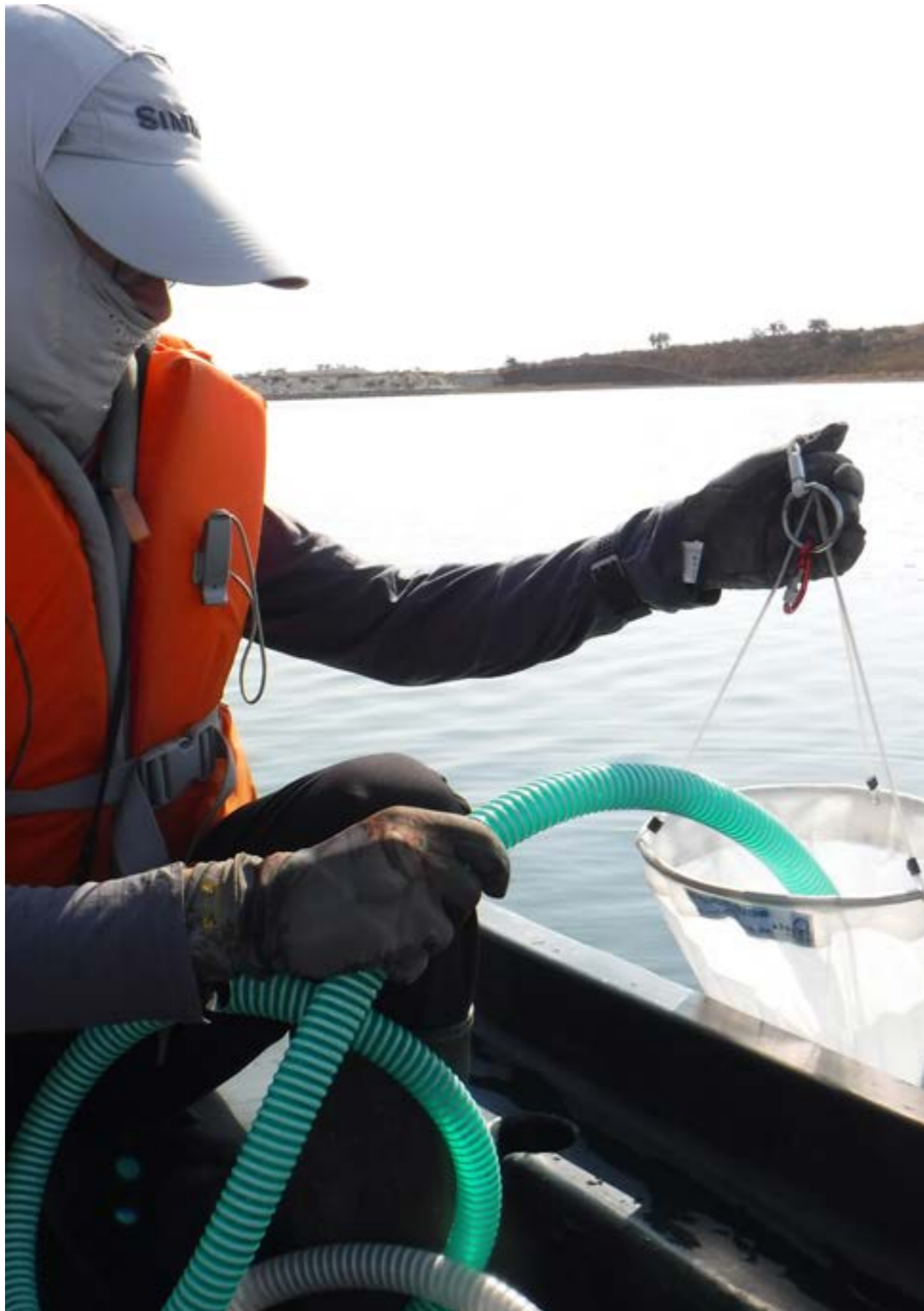
Para ajudar na deteção do mexilhão-zebra, pode recolher-se uma amostra de água com uma rede de plâncton. Foto: Mafalda Gama
